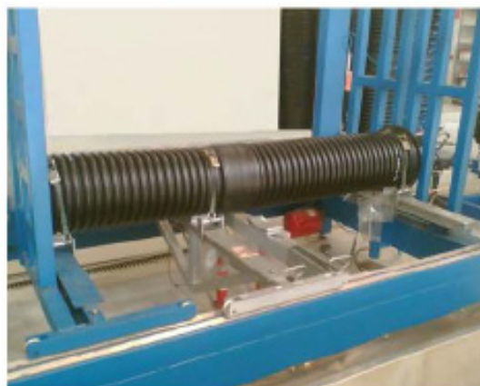
Prova di tenuta idraulica su una tubazione corrugata in polietilene DN/OD
